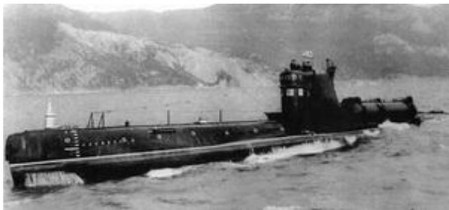
Подводная лодка проекта 644, дизельная, с крылатыми ракетами П-5; разработчик - ЦКБ-18 (КБ «Рубин»). С-80 была одной из шести дизельных подводных лодок проекта 644 переоборудованных из проекта 613. 8 декабря 1948 года зачислена в списки кораблей ВМФ СССР. 13 марта 1950 года заложена на эллинге ССЗ №-112 «Красное Сормово» в г.Горький, как головная средняя подводная лодка проекта 613.
