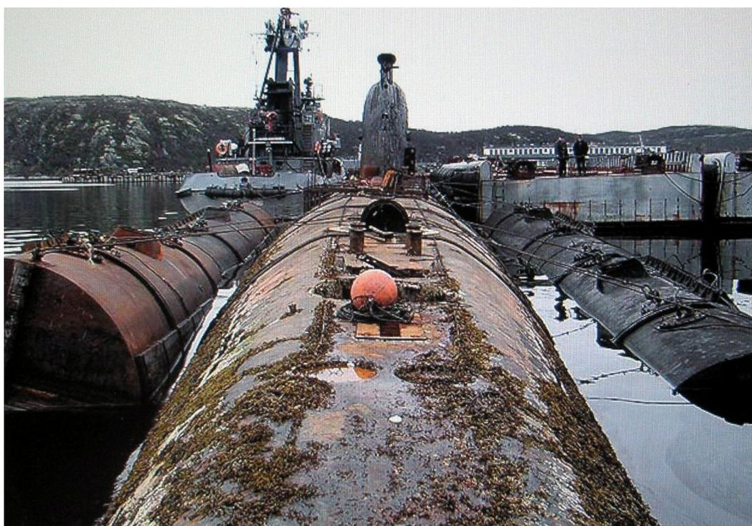
**Корпус подводной лодки Б-95 после подъема с грунта в губе Ура.
